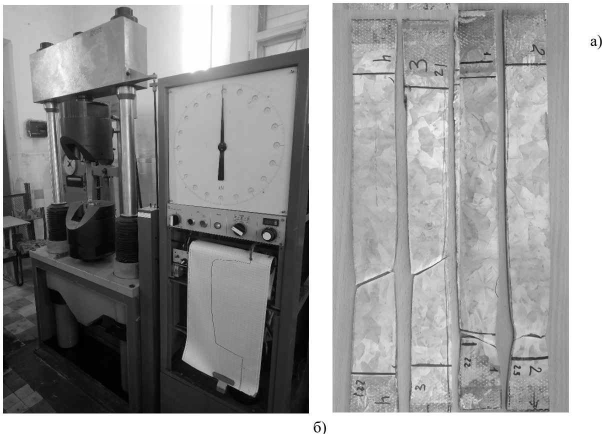
Рис. 2. Випробування на розтяг: а) загальний вигляд; б) зразки після випробування
