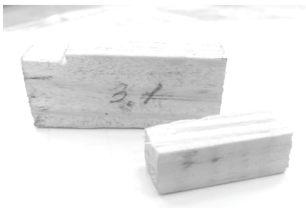
Рис. 2. Смешанное (адгезионно – когезионное) разрушений образца после испытания
