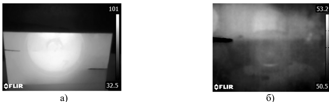
Рис. 3. Віддзеркалені інфрачервоні зображення а) лампа розжарювання, б) оператор та інфрачервона камера
