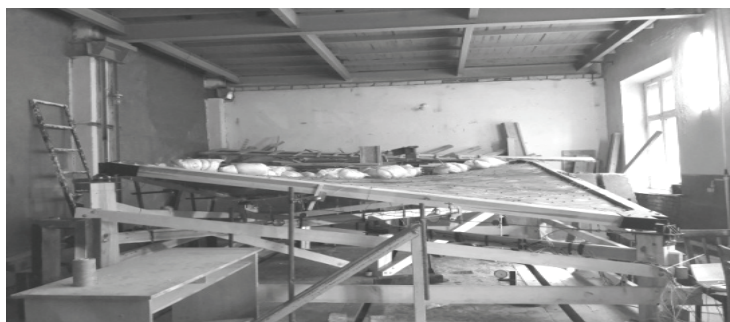
Рис.5 Испытания оболочки из параболических панелей.
