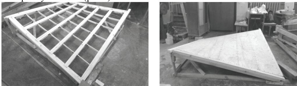
Рис.4 Вид оболочки из панелей в виде скрученного прямоугольника в лаборатории.
