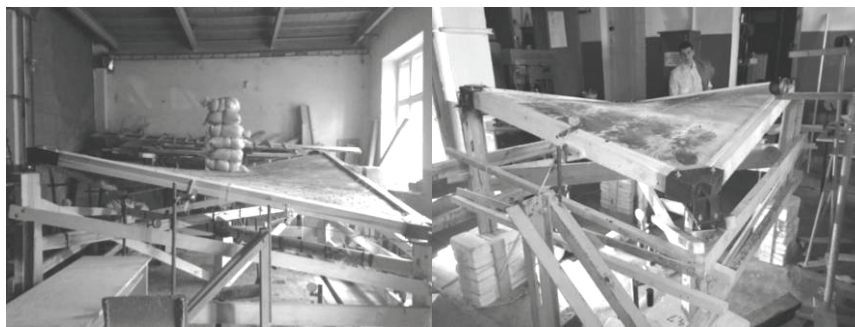
Рис.8. Вид с боку оболочки из параболических панелей размером 3х3м (с лево) и из асимптотических панелей 1,5х1,5м (с право).
