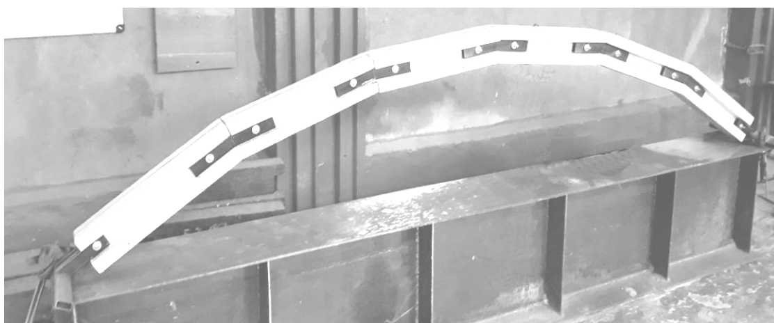
Рис. 4 Экспериментальная модель арочной полигональной конструкции пролетом 3м
