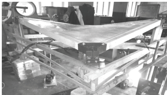
Рис.7 Вид оболочки размером 1.5x1.5м.
