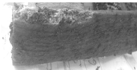
Рисунок 1. Образцы древесины сосны: а – до защитной обработки; б – после защитной обработки, размещенные в ящиках с землей и покрытые фрагментами трухлявой гнили; в – пораженный трухлявой гнилью необработанный образец
