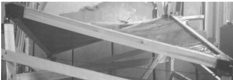
Рис. 5. Вид с боку оболочки из параболических панелей размером 3000х3000х35мм в лаборатории кафедры МДиПК ОГАСА.
