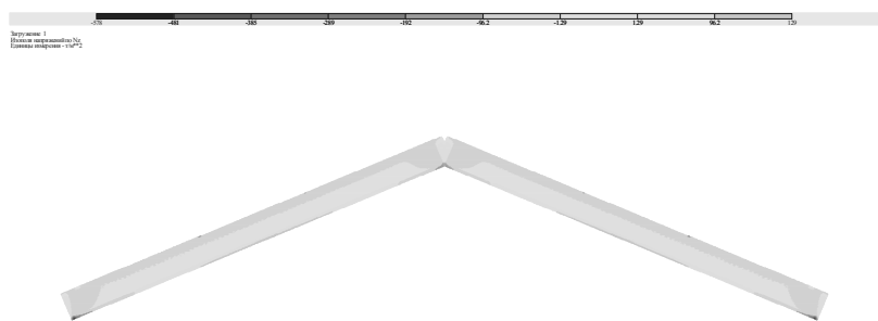
Рисунок 1.Изополя напряжений \sigma_z , т/м2 для линейного статического расчета элементов треугольной распорной системы без армирования
