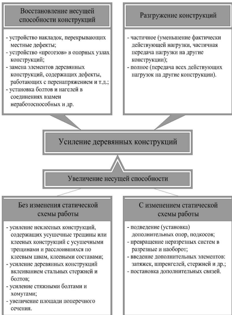
Рисунок 1. Способы усиления деревянных конструкций
