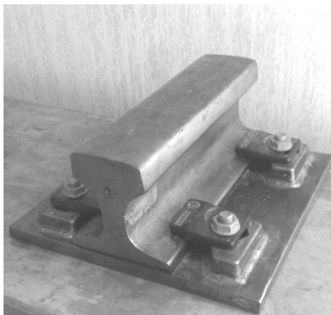
Рис. 2. Крепление рельса к верхнему поясу подкрановой балки
